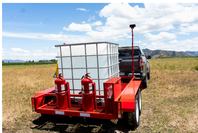
Vista posterior referencial · Extintores, caja e iluminación trasera.
